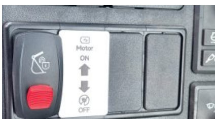
Safety starting system (안전 시동 스위치)
